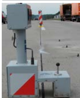
Messung des Plattenhöhenversatzes
